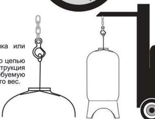
5. Поднимайте корпус с помощью подъемника или лебедки, как показано на рисунке. Поднимая корпус, никогда не обматывайте его цепью или стропами. Убедитесь в том, что конструкция подъемника позволяет поднять корпус на требуемую высоту и подъемник в состоянии выдержать его вес.
