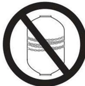
6. При подъеме корпуса используйте такелажную балку с гладкой поверхностью.
